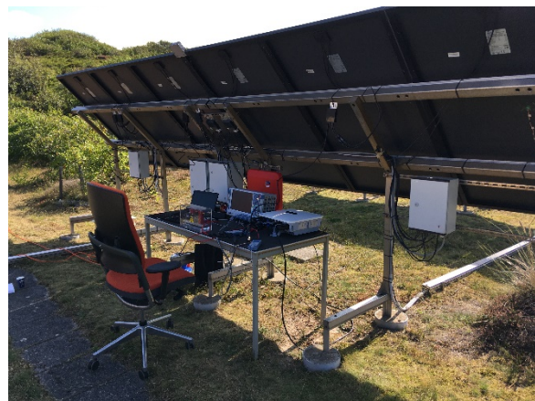
Figuur 2. Buiten-faciliteit voor het testen van vlamboogdetectie bij een echt PV systeem.
